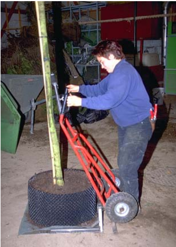
Bild 7 Der Spezial-Schubkarren wird am Tragblech angedockt.
